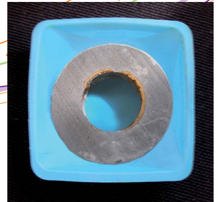
Dissolution et carbonatation en présence de CO 2 , mesurées en laboratoire sur un échantillon de ciment.
