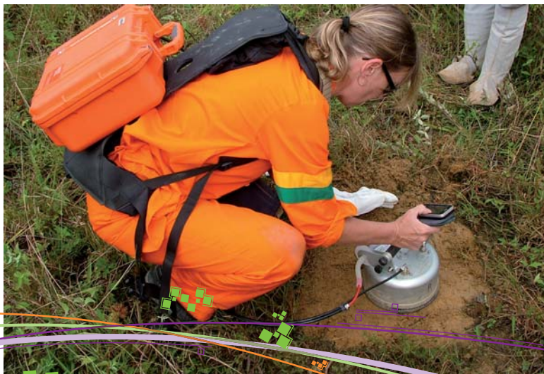
Chambre à flux utilisée pour établir une ligne de base géochimique en phase de préinjection.
