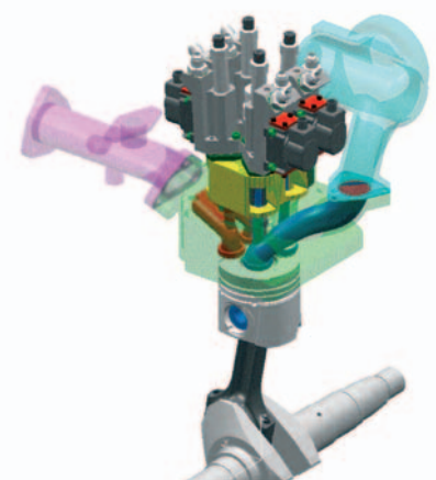
Vue schématique du moteur monocylindre IFP avec système VVA Lotus
