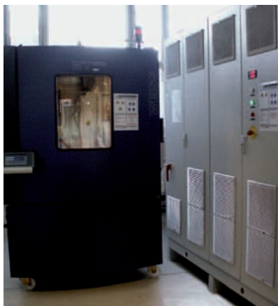
L'IFP s'est équipé d'un banc d'essais dédié à l'évaluation des systèmes de stockage d'énergie (batteries de traction et supercondensateurs).
