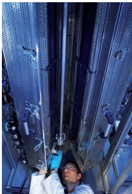
L'IFP a développé et mis en œuvre en 2008, au sein du pôle Axelera, un dispositif expérimental d'adsorption réactive (le One Column réactif) permettant d'améliorer l'efficacité énergétique des procédés en couplant les opérations de réaction et de séparation.
