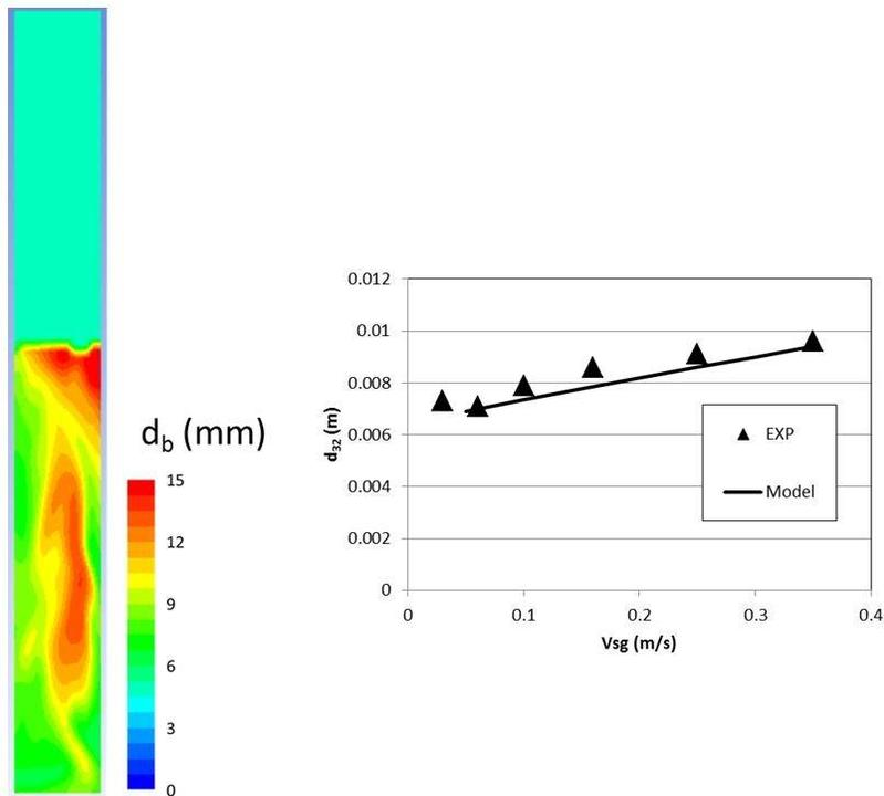
Prévision par calcul de diamètres de bulles et comparaison avec les données expérimentales (colonnes à bulles Ø 400 mm, système eau-air).
