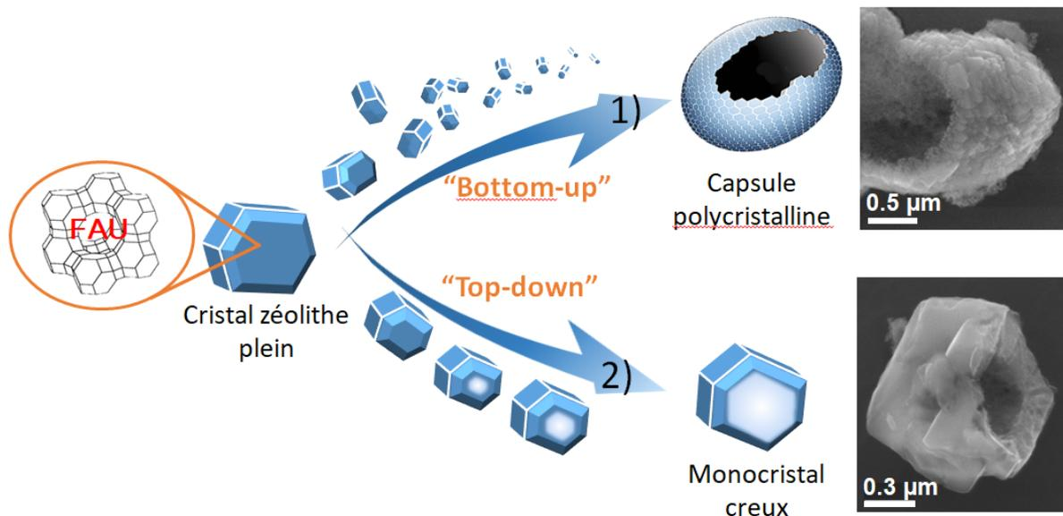
Les deux voies de synthèse développées permettant d'obtenir des cristaux creux de zéolithe FAU.
