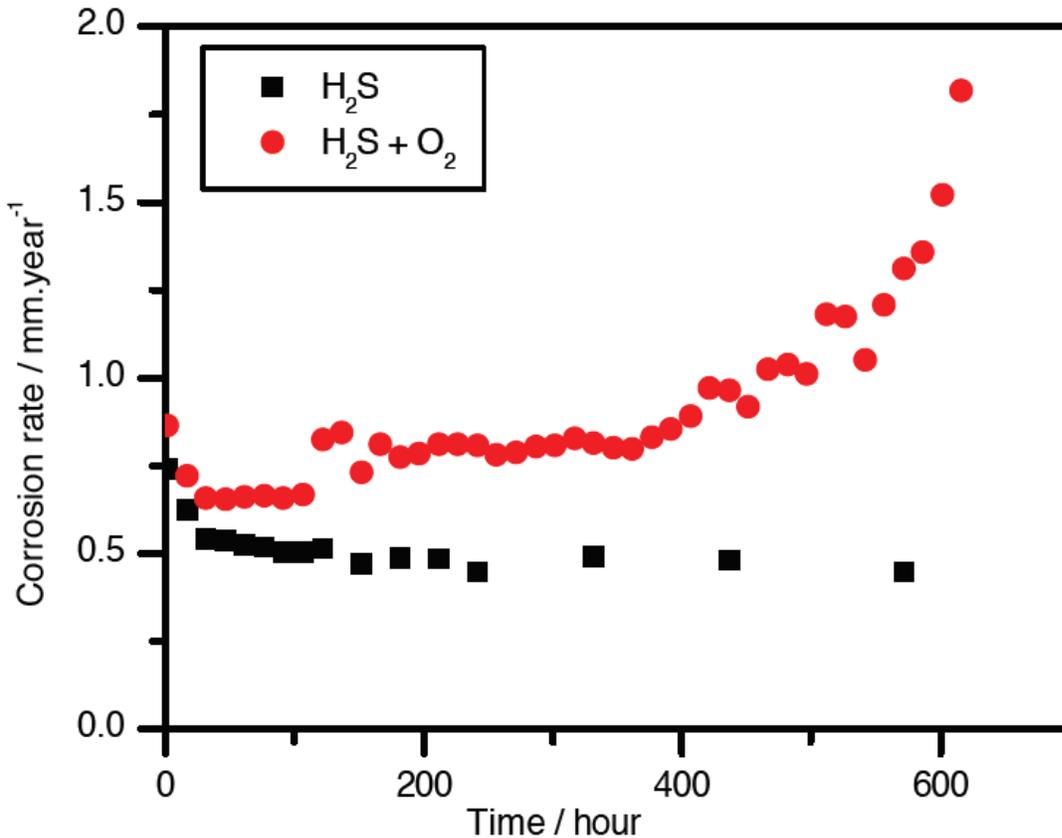
Évolution de la vitesse de corrosion d'un acier en milieu aqueux contenant de l'H<sub>2</sub>S dissous, en absence ou présence d'oxygène.
