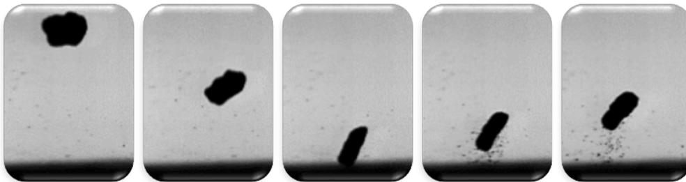
Afin de décrire l'attrition dans la région des jets de gaz et dans les cyclones, ces résultats ont été corrélés avec ceux mesurés sur des outils à l'échelle du laboratoire et du pilote, pour différentes propriétés de particule (diamètre, densité, dureté, tenue à la rupture) et conditions opératoires. Ces corrélations ont été ensuite utilisées **pour estimer l'attrition dans les différentes zones d'un CFB.**
