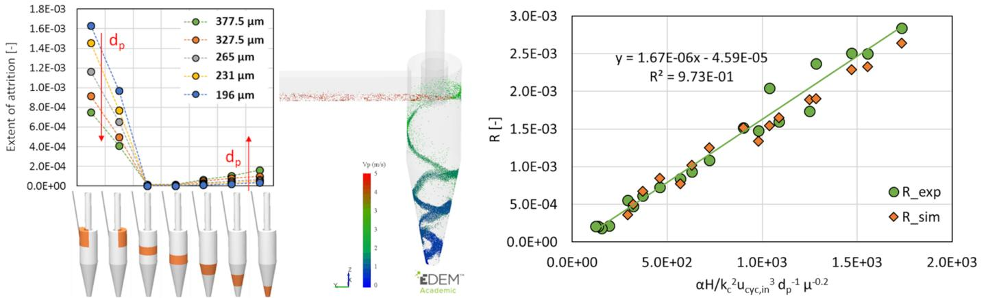
Les corrélations établies dans les différentes zones d'attrition (figure ci-dessus à gauche) ont ensuite été mises en œuvre dans un **modèle de bilan de population (PBM<sup>5</sup>)** afin de simuler le comportement dynamique d'un lit fluidisé circulant, avec appoint de solide.
