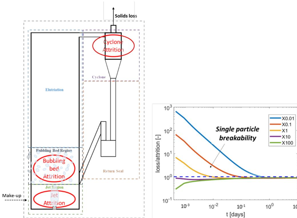
**Le PBM est alors utilisé pour prédire, à l'échelle du procédé complet, l'évolution de la distribution granulométrique des particules et la perte de solide par attrition.** C'est ce que montre la figure ci-dessus (à droite), sur laquelle est présentée la prédiction de la perte de solide par attrition dans tout le système en fonction du temps, pour différents niveaux de fragilité des particules (« particle breakability »).
