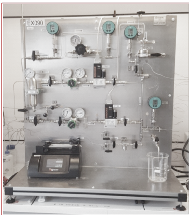
Cellule d'analyse in situ pour le suivi par Quick-XAS de l'activation des catalyseurs en conditions industrielles.
