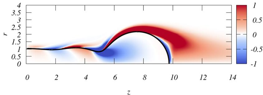
Goutte axisymétrique se rétractant. Les contours de vorticit  illustrent l'apparition d'ondes capillaires.
