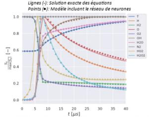
Comparaison entre la solution exacte et la solution par réseau de neurones dans le cas d'une combustion d'hydrogène  $(H_2)$
