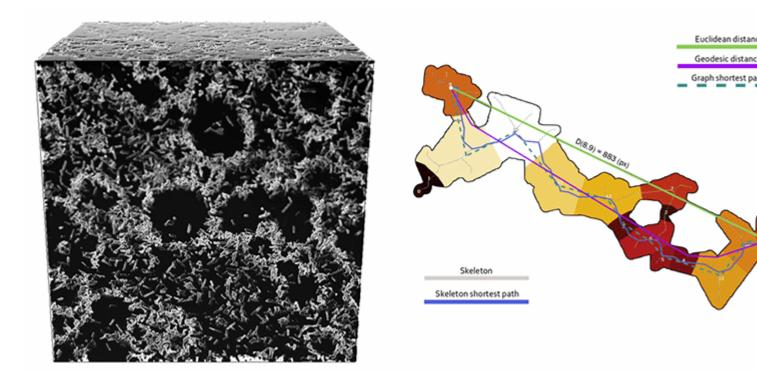
À gauche, simulation numérique d'une microstructure d'un matériau poreux. À droite, illustration d'un opérateur de tortuosité, rapport des longueurs des chemins entre deux points par « vol d'oiseau » (distance Euclidienne) et contrainte par le réseau poreux (distance géodésique).
