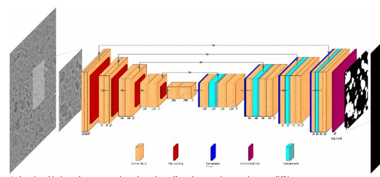
Animation décrivant la segmentation sémantique d'une image microscopique en différentes zones d'hétérogénéité de porosité avec un réseau de neurones convolutifs.
