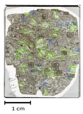
Figure 2 : Détection automatisée de microfossiles sur une lame mince de roche. Chaque rectangle généré par l'algorithme délimite une zone comprenant un microfossile. Sa couleur correspond à l'espèce la plus probable selon le modèle (ex : vert pour les nummulites, marron pour les alvéolines)
