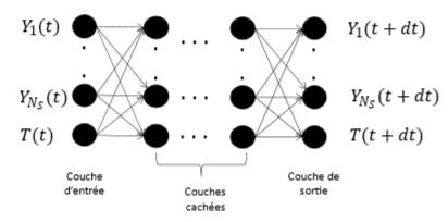
Illustration de l'approche de résolution par réseau de neurones dans le cas de la combustion de H2
