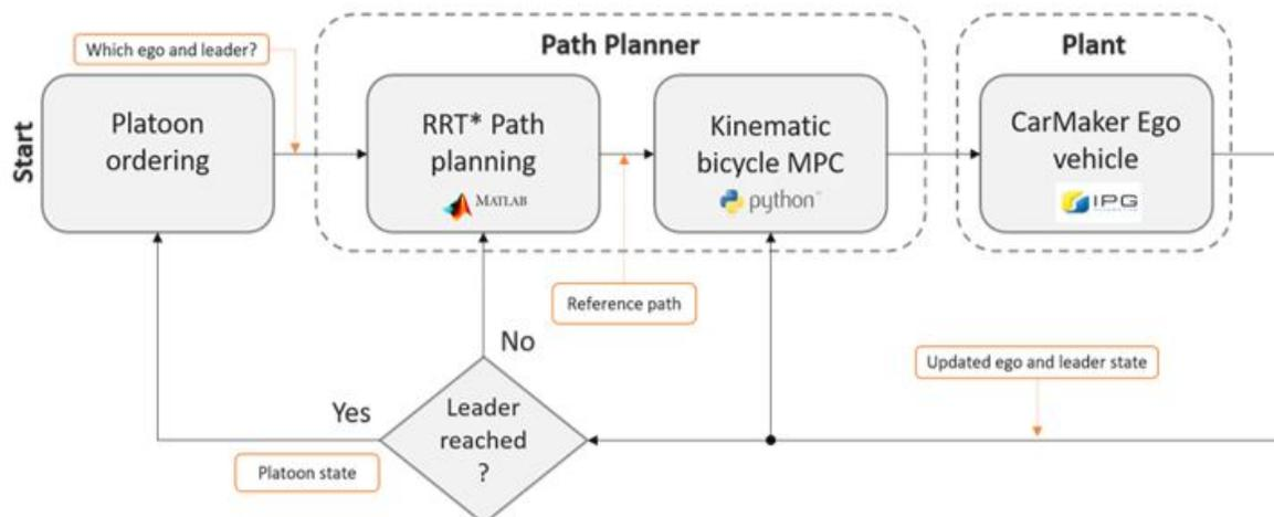
Figure 2. Algorithme de mise en œuvre du planificateur de trajectoire.
