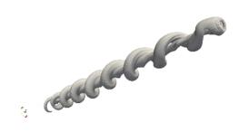
Figure 2 : Bulle ascendante suivant une trajectoire en forme de spirale
