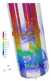
Figure 1 : Calcul MRF (Model Reference Frame) sur un réacteur agité dédié au recyclage des plastiques
