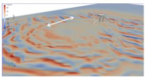
Figure 4: Mouvements de corps flottant en oscillation libre amortie sans houle, donnant naissance à un champ de vagues radiées
