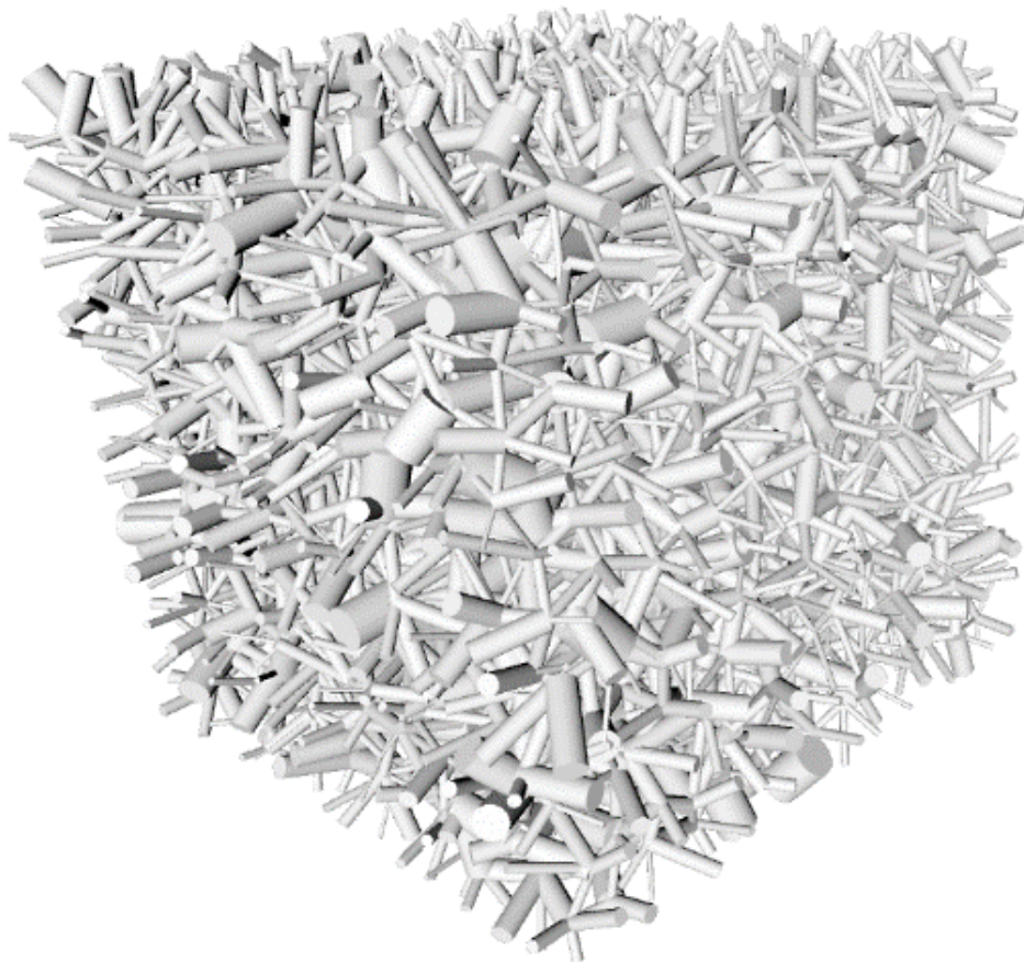
Figure : Volume élémentaire représentatif du jumeau numérique d'une alumine réelle.
