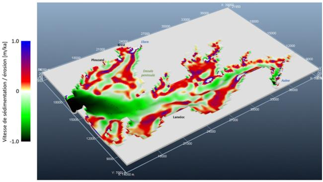
Figure 3: Simulation stratigraphique de l'évolution du fond marin de la rade de Brest réalisée avec DionisosFlow (logiciel IFPEN), en s'appuyant sur la modélisation numérique des courants marins [3]
