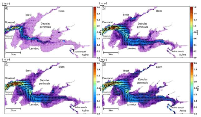
Figure 2: Simulation hydrosédimentaire des courants de flot réalisée avec Mars 3D (logiciel Ifremer), à quatre étapes clefs de l'ennoiement de la rade de Brest [2] : (a) 9000 ans BP (before present), niveau de la mer = -26 m par rapport à l'actuel ; (b) 7500 ans BP, niveau de la mer = -5 m ; (d) aujourd'hui.
