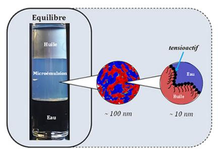
Figure 1 : Exemple de microémulsion bicontinue ; le schéma au centre donne une représentation de la phase bicontinue ou phase éponge à l'échelle de 100 nm ; le schéma de droite donne une représentation du film interfacial, constitué de tensio-actifs, séparant l'huile et l'eau dans cette phase bicontinue à l'échelle de 10 nm.
