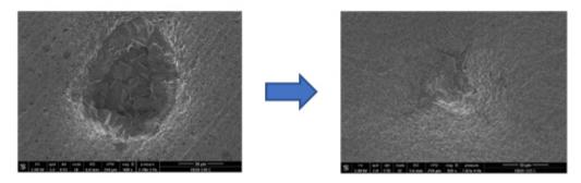
Figure 2 : Images MEB de la reformation d'une couche pseudo-passive sur une piqure après arrêt de la contamination par l'oxygène.
