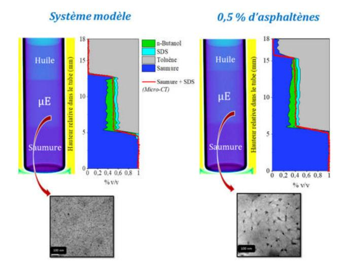
Figure 2 : Compositions et épaisseurs des phases des microémulsions déterminées sur un système modèle (saumure 54 g/L NaCl/SDS(c)/n-butanol/toluène) et un système avec 0,5 % d'asphaltènes.
