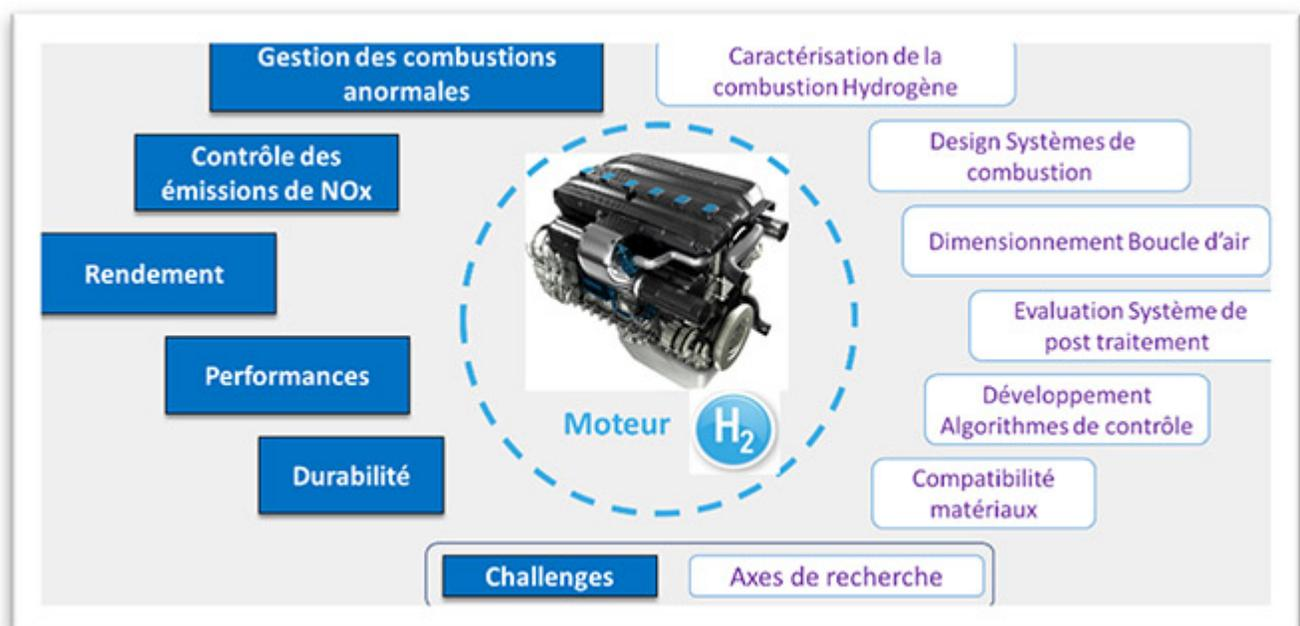
Figure 1 : Défis concernant l'utilisation de l'hydrogène dans un moteur thermique et axes de recherche IFPEN
