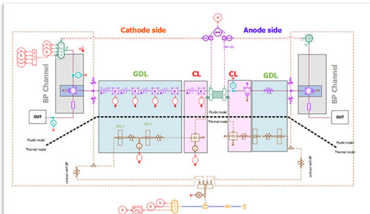
Figure 4 : Modèle d'une cellule de pile à combustible permettant la prise en compte détaillée des phénomènes électrochimiques et thermiques (plateforme Simcenter Amesim®)
