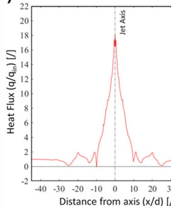
Figure 1: Essai de jet liquide impactant une plaque chaude.
