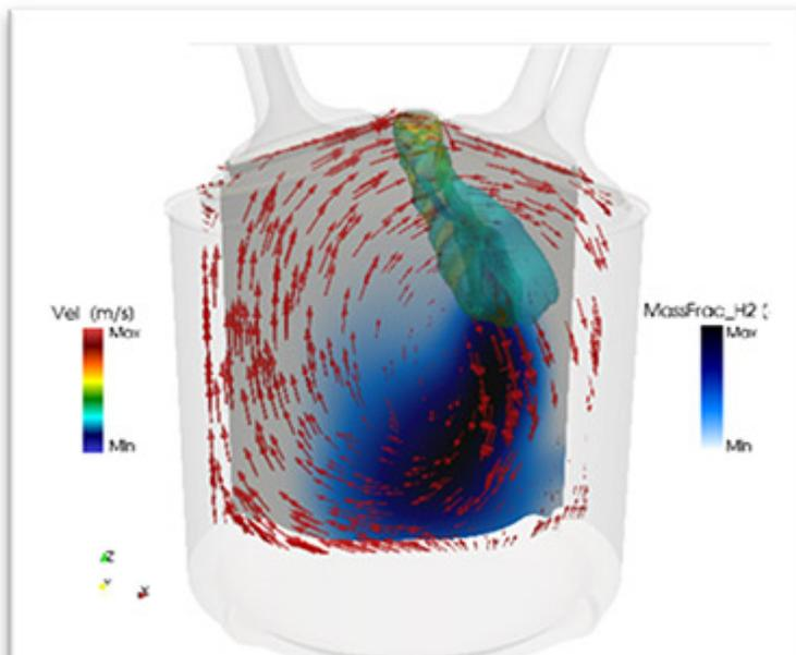
Figure 3 : Simulation de l'injection du mélange H<sub>2</sub>/air dans une chambre de combustion moteur
