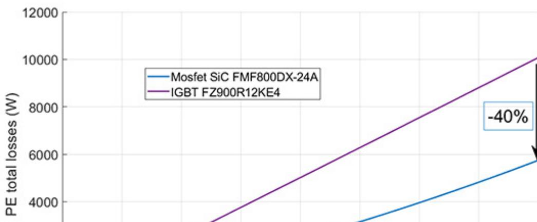
Figure 1 - Comparaison des pertes d'une carte électronique de puissance avec composants similaires en carbure de silicium (MOSFET SiC) et en silicium (IGBT) selon différents niveaux d'amplitudes de courants moteur électrique.
