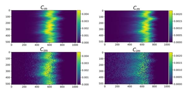
Figure 1: champs de concentration pour Da=1/8 (gauche) et Da=1/40 (droite). Cm représente la concentration dans la zone mobile et Ci la concentration dans la zone immobile
