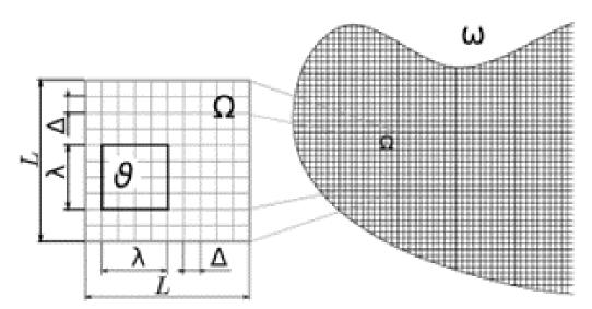
Figure 1 : le modèle fin est simplifié en agrégeant les mailles fines de taille D en mailles de taille lambda>D . Pour garder le contrôle, la simulation est réalisée sur des sous volumes W et en faisant varier lambda l'évolution de la distribution des conductivités peut être quantifiée en fonction de l'échelle de prise de moyenne. Cela permet d'identifier des comportements à grande échelle : percolant, non percolant, homogénéisable ou non etc...
