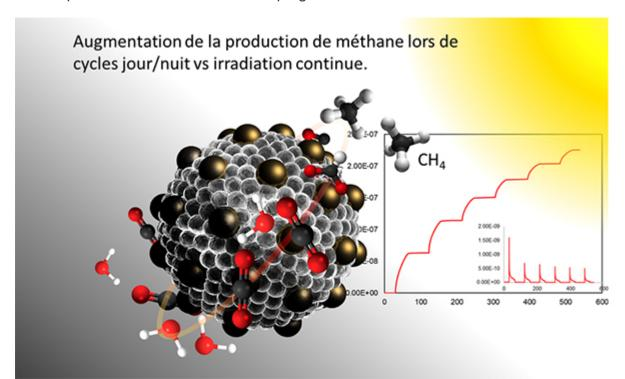
Figure 3 : Représentation du cocatalyseur de platine sur TiO2, des réactifs et des produits de photo réduction du CO2. Le graphique indique l'évolution de la quantité cumulée de CH4 produit et de sa dérivée (abscisse en minutes).
