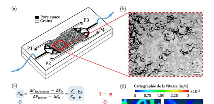
Figure 1 (a) Représentation schématique du micromodèle utilisé. P1/P2/P3 et P4 correspondent à des prises de mesures de pression.
