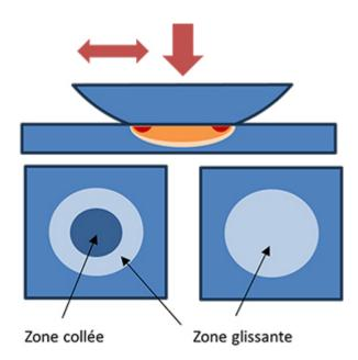
Figure 1 : Schéma d'une sollicitation en fretting avec les deux régimes de glissement possibles : glissement partiel à gauche et glissement total à droite.
