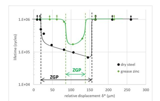
Figure 3 : Courbes de fretting fatigue pour le contact sec entre fils acier (noir) et le contact graissé entre fils galvanisés (vert). Chargement en fatigue et force de contact constantes. Glissement relatif entre les fils en abscisse et durée de vie en ordonnée. La combinaison du zinc et de la graisse améliore notablement la durée de vie. ZGP : zone critique d'endommagement en glissement partiel
