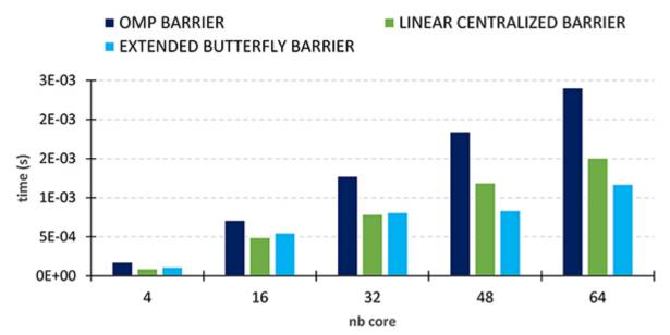
Figure 2 : Résultat des temps de synchronisation des barrières sur le processeur AMD Milan.
