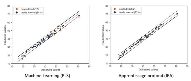
Figure 2 : Diagramme de parité – Distillats moyens (gamme spectrale réduite entre 4500-1200 cm-1)
