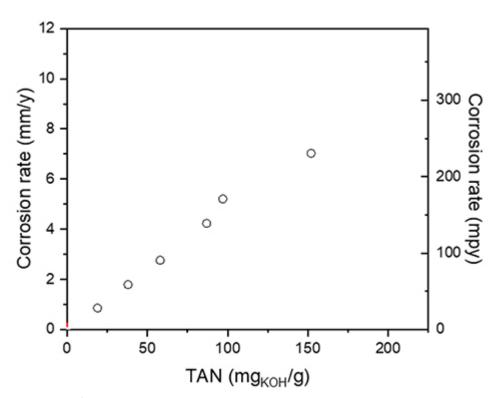
Figure 2 : Influence du TAN sur la vitesse de corrosion de l'acier au carbone AISI 1018 lors d'essais d'immersion à 220°C (mélange d'huile de colza et d'acide oléique).
