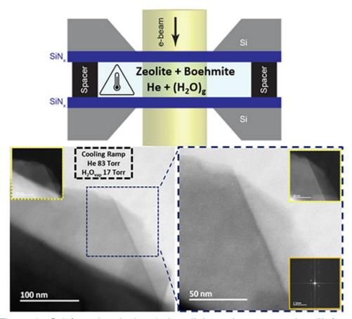
Figure 2 : Schéma de principe de la cellule environnementale utilisée en microscopie en transmission. Les images montrent, pour deux grandissements, les évidences morphologiques et structurales des effets de la désalumination de la zéolite par hydrolyse.
