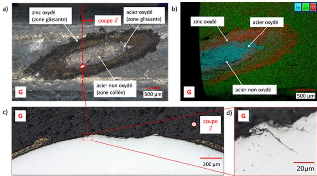
Figure 2 : Essai de fretting simple interrompu sur fils zingués, a) vue optique de la trace, b) vue EDX de la trace (affichage de l'oxygène, du zinc et du fer), c, d) vues optique de la coupe axiale.
