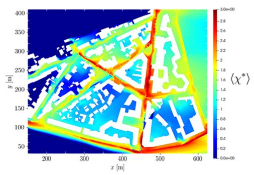
Figure 1 : Exemple de carte de concentration de polluants simulée par la chaine de calcul décrite dans [1] pour un guartier de la ville d'Issy-les-Moulineaux.
