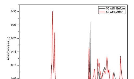
Figure 3 : Spectre infrarouge d'une huile végétale acide avant et après test de corrosion.
