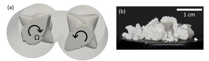
Figure 1 : (a) Schéma de la cuve de malaxage (volume de 80 cm3). (b) Photo d'une pâte de boehmite à pH = 6,2, prise hors du malaxeur.
