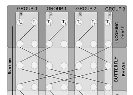
Figure 1 : Schéma d'échanges de notifications entre les cœurs dans la barrière Extended Butterfly avec 7 cœurs de calcul.
