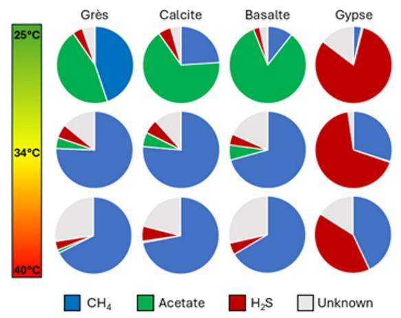
Figure : Influence de la température et de la minéralogie sur les proportions d'hydrogène (en %) converti par diverses voies métaboliques
