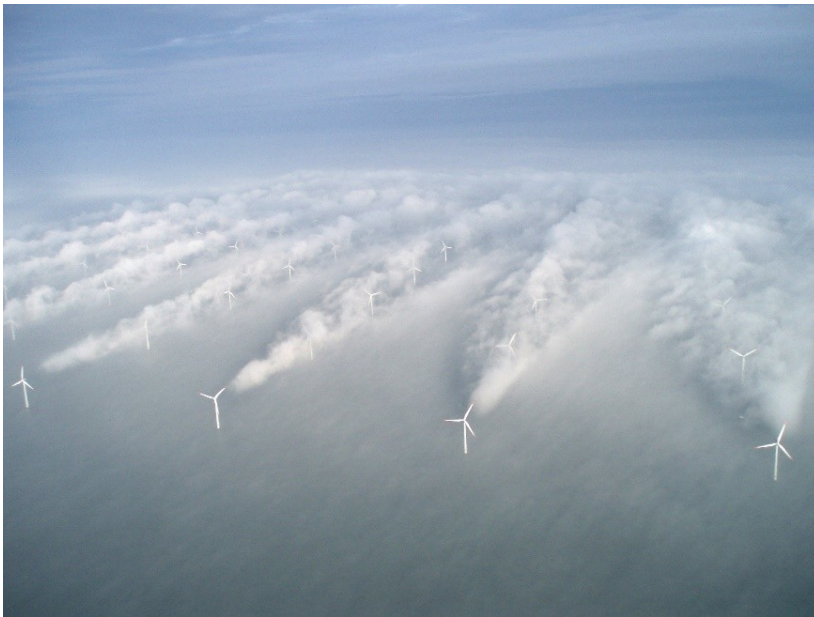
Figure 1 : Photo aérienne des effets de sillage visibles sur le parc éolien en mer Horns Rev 1 - Copyright Vattenfall
