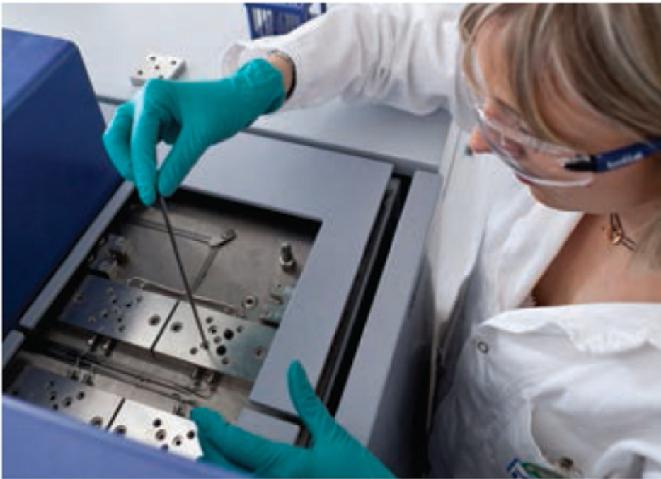
Chargement des réacteurs sur un équipement EHD.
