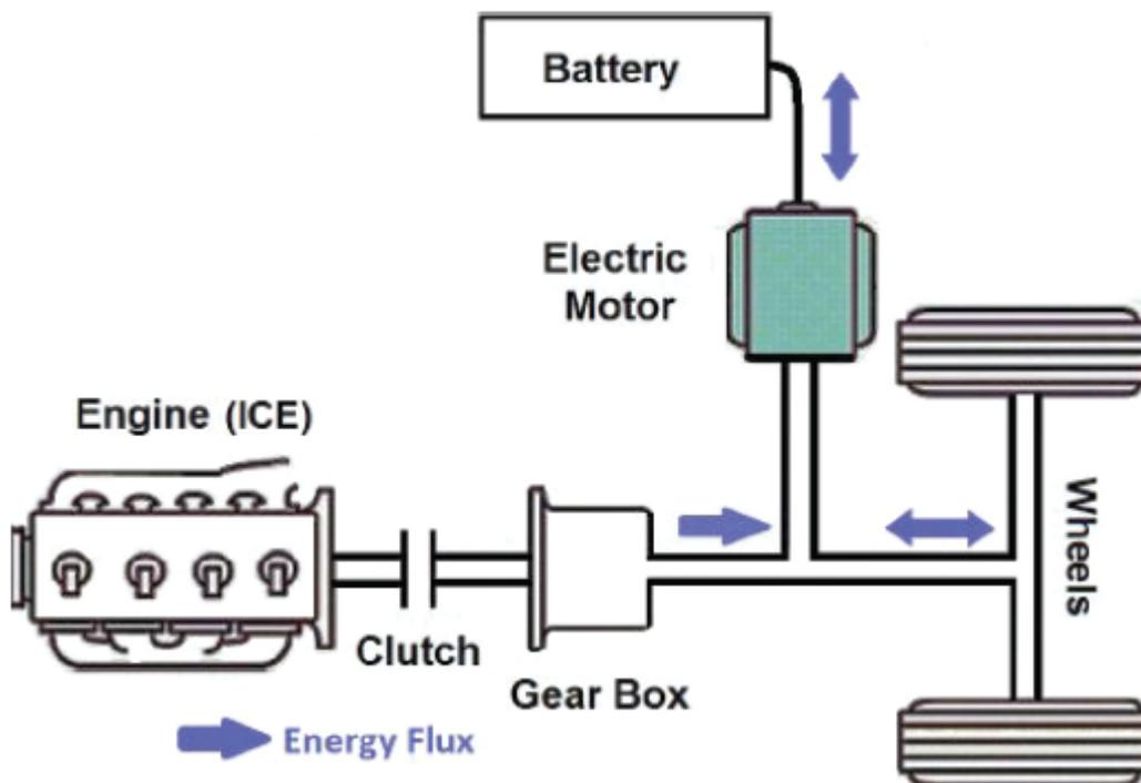
Flux d'énergie dans un véhicule hybride, à contrôler par le gestionnaire embarqué.
