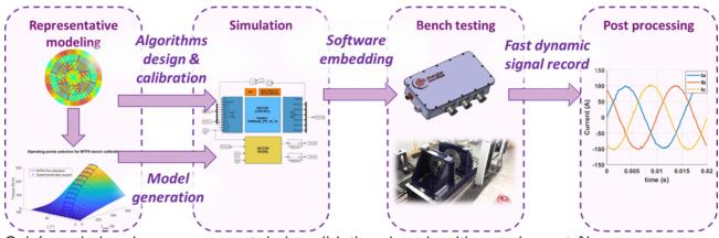
Schéma de la mise en œuvre et de la validation des algorithmes de contrôle
