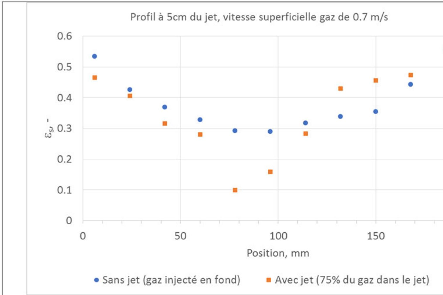
**Figure 3 : Profils de fraction volumique solide dans le lit sans et avec jet vitesse superficielle gaz de 0,7 m/s**
