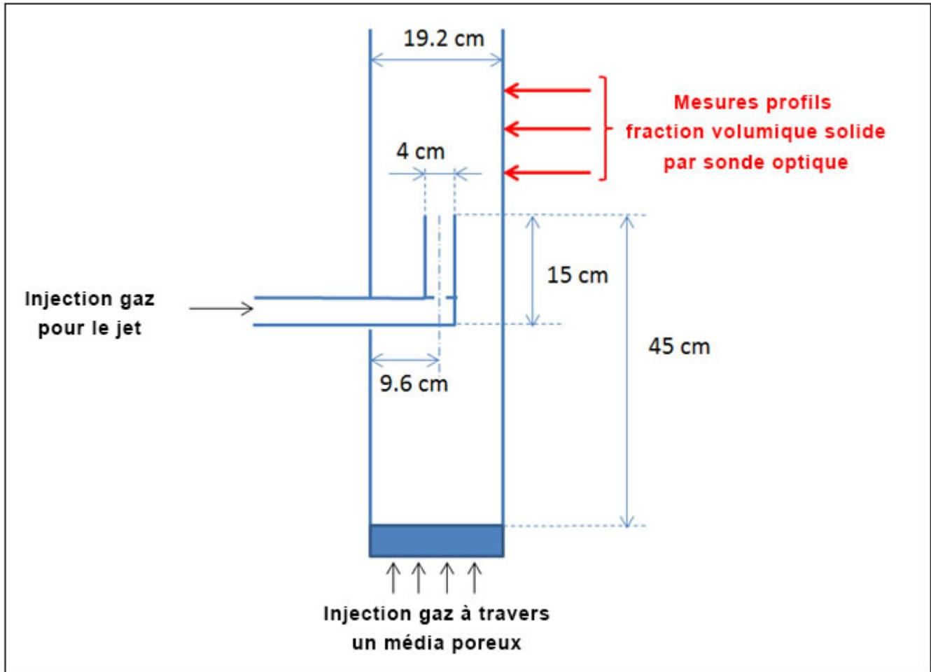
**Figure 2 : Lit fluidisé circulant utilisé pour les expérimentations**
