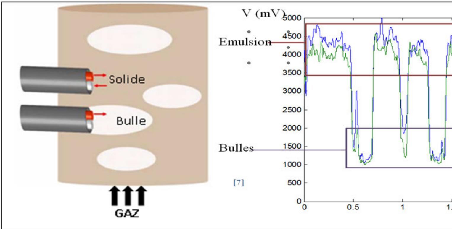
**Figure 1 : Signal d'une sonde optique dans un lit fluidisé**
