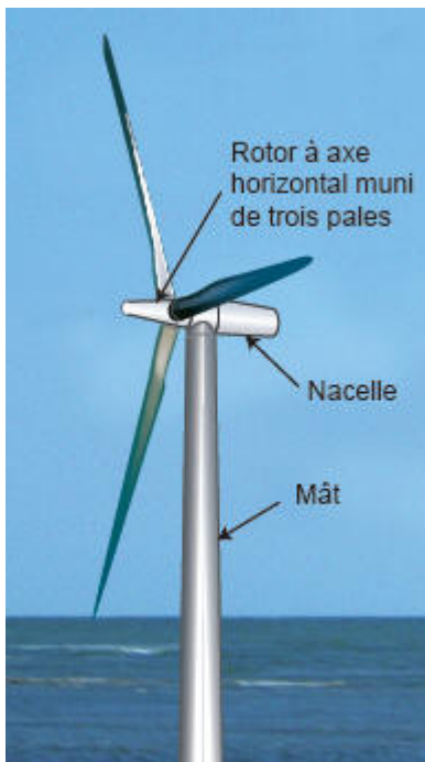
Les composants d'une éolienne
