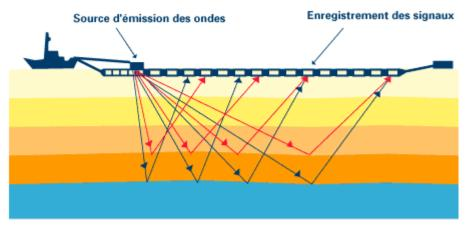
Le principe de la sismique est simple : on provoque de légers ébranlements (chute d'un poids, petite explosion...) et on suit les signaux ainsi émis, qui se réfléchissent sur certaines discontinuités géologiques.
