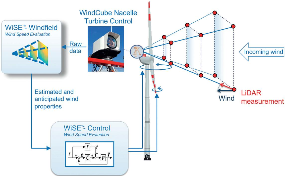
La connaissance du vent incident en temps réel mesuré par lidar permet le contrôle d'éoliennes et de parcs et l'optimisation de la production. IFPEN développe différentes solutions de contrôle dans ce domaine :
