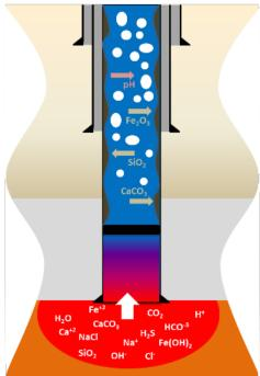
Quelques éléments chimiques aux abords d'un puits pris en compte par GWELLFM
