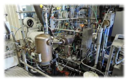
Banc H2 monocylindre véhicule léger
