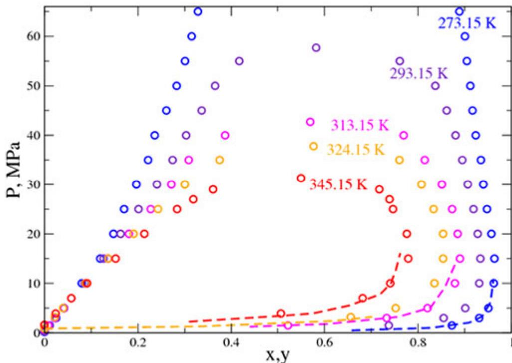
Exemple de diagrammes pression-composition générés à l'aide de la simulation moléculaire, pour un système binaire dioxyde de soufre / monoxyde d'azote.
