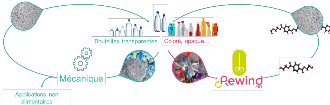
Recyclage chimique complémentaire du plastique PET coloré et opaque en boucle fermée
