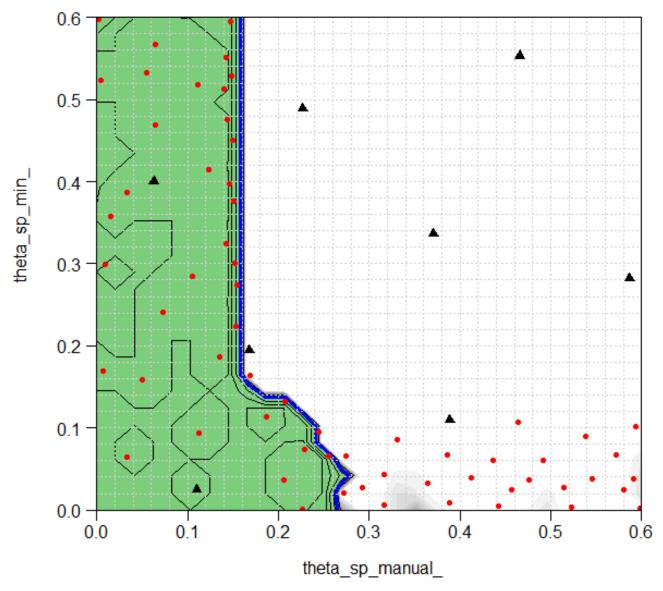
Pour deux paramètres de contrôle, estimation (en vert) du domaine de respect de la norme d'émissions de NH3 (points initiaux simulés en noir, points ajoutés par la méthode itérative
