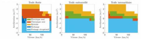
Loi de gestion d'énergie du véhicule hybride en fonction de trois conditions de trafic sur un tronçon routier.
