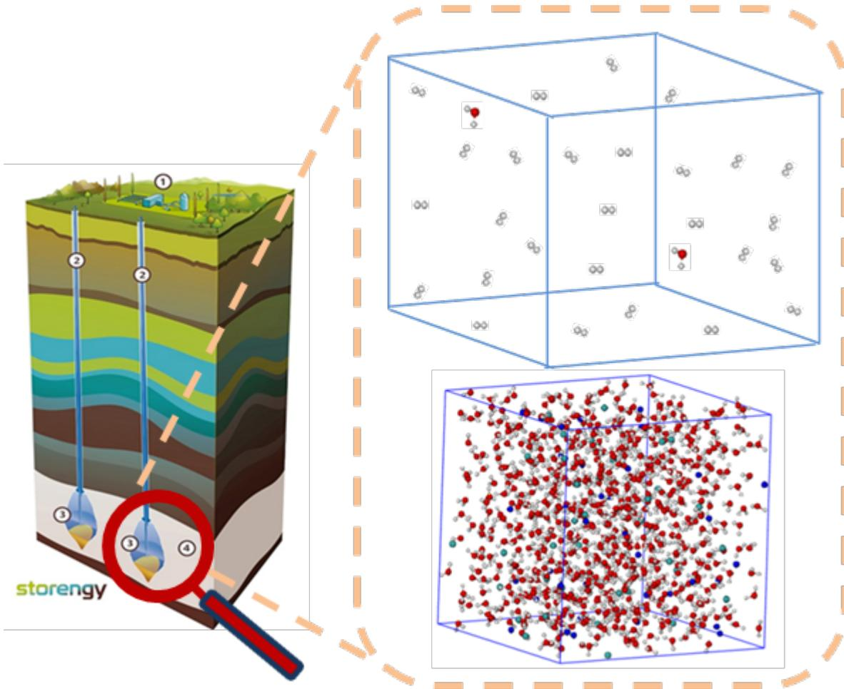
**Principe de la méthodologie** : l'équilibre de phase se produisant au sein d'un stockage géologique est déterminé à travers des simulations moléculaires de type Monte Carlo. Les données d'équilibre générées peuvent alors être utilisées pour calibrer des lois empiriques utilisées par les opérateurs
