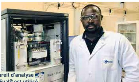
L'appareil d'analyse Rock-Eval® est utilisé pour la caractérisation du carbone dans les sols.
