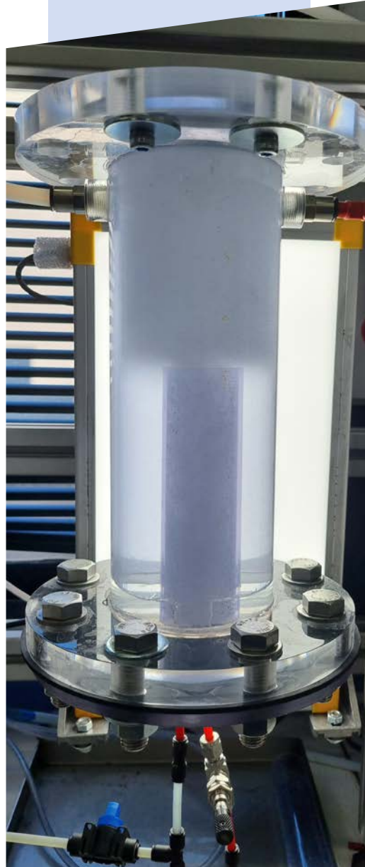
Colonne de flottation à double enveloppe
