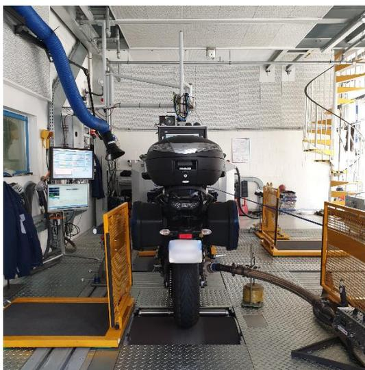
Figure 3 : Installation de la moto 1 au banc à rouleaux d'IFPEN
