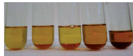
Évolution du carburant lors de phases d'oxydation.
